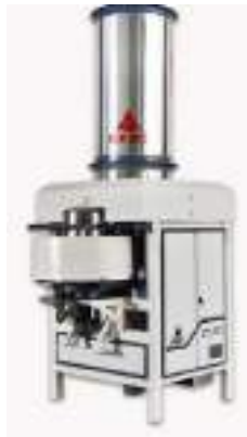
Слика 7. Мешалка за производство на алуминиумска паста
