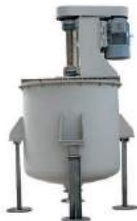
Слика 6. Машина за мешање и дозирање на калапи
