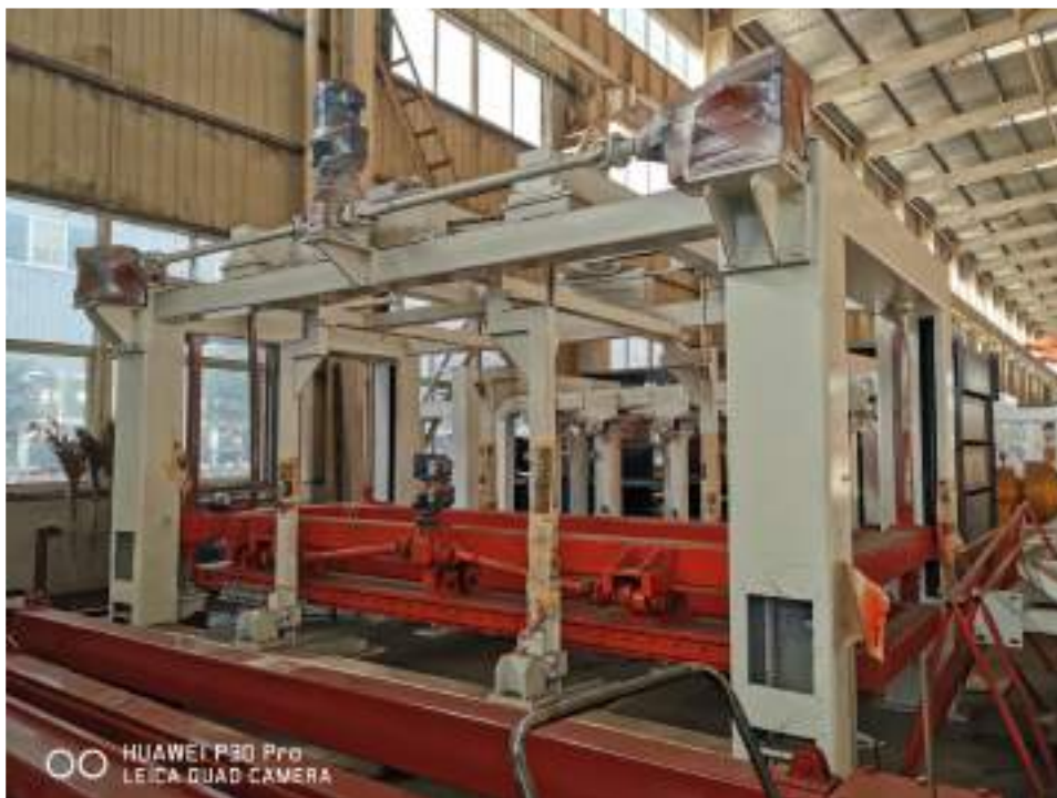
Слика 9. Гатер за сечење на блокови (вертикално)
